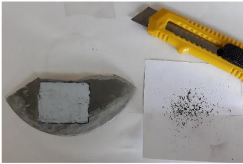
Şekil 2; Kir toplanan izolator yüzeyi
