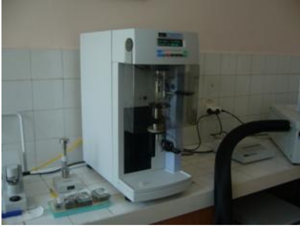
Şekil 10;Pelkin-Elmer Pyris II TGA cihazı
