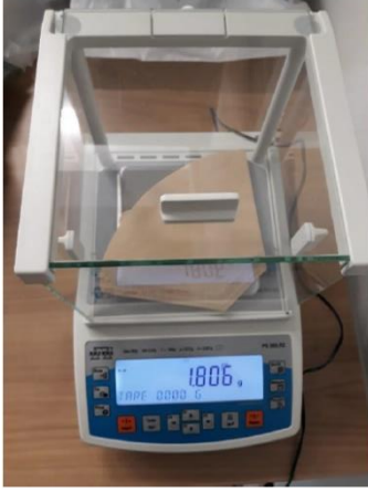
Şekil 4; Test için kullanılan 1 mg hassasiyetli hassas terazi
