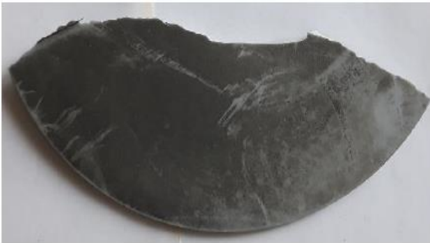
Şekil 1; ESDD ve NSDD hesapları için alınan numune örneği.
