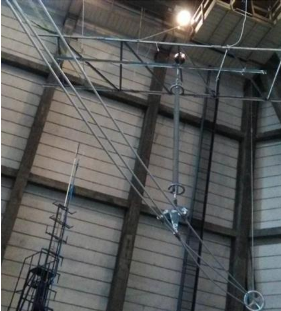
Şekil 29; 420 kV I Askı Takımı için Test Düzenegi
