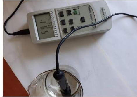
Şekil 3; Kir içeren çözeltinin iletkenlik ölçümü.
