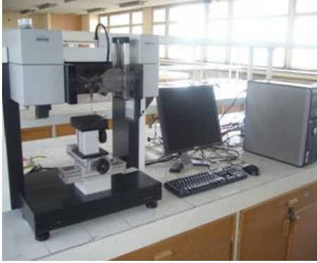
Şekil 13;Hidrofobisite ölçümünde kullanılan Kruss DS100 Temas Açısı Cihazı
