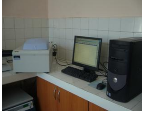
Şekil 21;T g belirlenmesi çalışmalarında kullanılan Pelkin Elmer marka DSC cihazı
